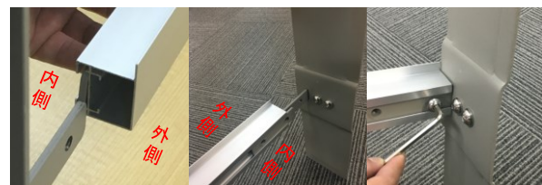
4. 本体のアルミフレームの中(断面図のCの字部分、点の塗潰し部分)に脚のL型金具を入れて、内側から長いボルトでL型金具を固定する。
