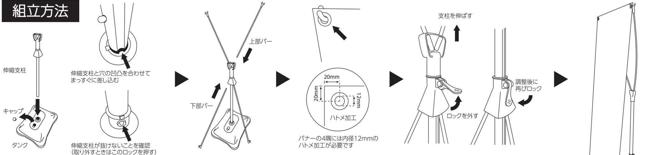
タンクのキャップを外して注水してから伸縮支柱を差し込む
