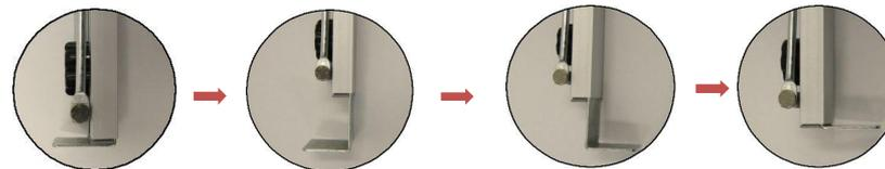
ボードを垂直に表示する場合、前に倒れにくいように金具が装備されています。下部の黒いネジをゆるめてL字の金具を引き抜きます。金具の向きを変えて再びボード取り付けバーに差し込み、黒いネジで固定します。
